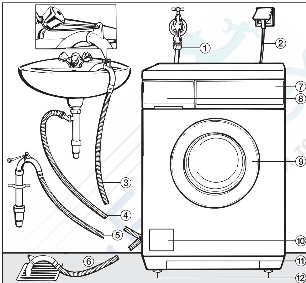
① Шланг для залива воды (максимально допустимое давление 7.000 кПа)
